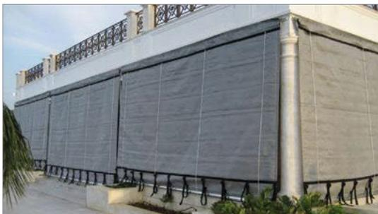
**Figura 4-13.** O para-brisas de tecido de cestaria de polietileno é implantado na borda do pátio, abrangendo toda a área. Imagem cortesia de Roll-a-way.
