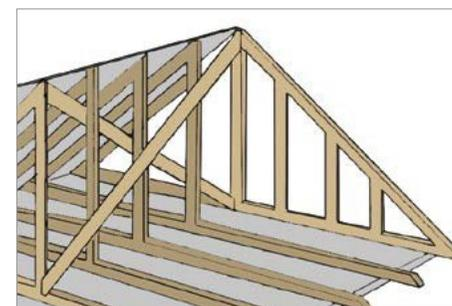
**Figura 4-4.** As chaves diagonais formam um padrão X do centro superior da extremidade da empena até o centro inferior da quarta treliça e do centro inferior da extremidade da empena até o centro superior da quarta treliça. São utilizados os mesmos parafusos da bandagem lateral. Fonte: FEMA's Against the Wind brochure 247.
